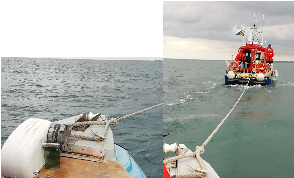
Détail de l'amarrage, mise en traction et remorquage
